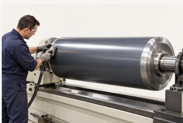
17 Renovação de revestimento em cilindros
