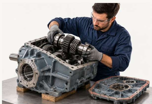
16 Recuperação de conjunto mecânico e substituição de peças danificadas
